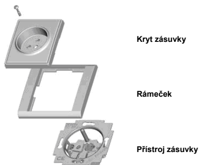
Obr. 5: Sestavování jednonásobné zásuvky s krytem a rámečkem
