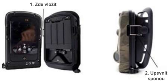
Obrázek 4: Připevnění GSM modulu
